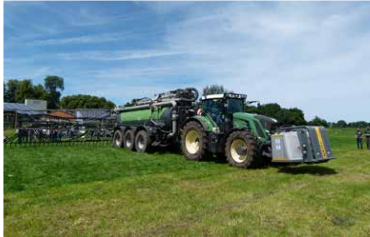
Für eine verbesserte Ausnutzung von Wirtschaftsdünger ist ein Fortschreiten der Technik, wie die Zugabe von Schwefelsäure zur Minderung von gasförmigen Ammoniakverlusten, unabdingbar. Foto: Peter Lausen
